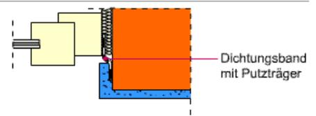
Abdichtung der Fuge zwischen Fensterblendrahmen und Mauerwerk mit Dichtungsbändern
