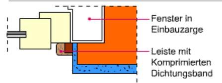
Prinzipische Skizze zur Abdichtung der Fuge zwischen Fensterblendrahmen und Mauerwerk mit imprägnierten Schaumkunststoffbändern
