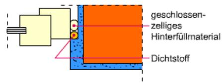
Prinzipische Skizze zur Abdichtung der Fuge zwischen Fensterblendrahmen und Mauerwerk mit spritzbarem, elastischem Dichtstoff und Hinterfüllmaterial
