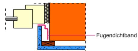
Prinzipische Skizze zur Abdichtung von Fensterblendrahmen mit Elastomer-Fugendichtungsbändern
